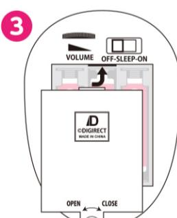
電池をセットしたら電池ブタを取り付けてネジを締めてください。
