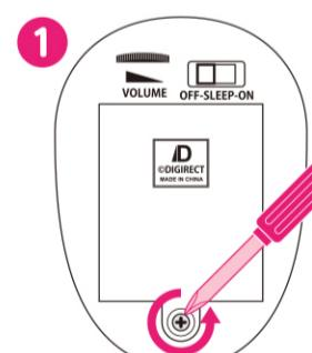
電池ボックスのネジをプラスドライバーで緩めて電池ブタを取り外します。
